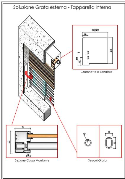
Grata di sicurezza a scomparsa elettromeccanica a discesa verticale per finestre anche di grande dimensione, con motorizzazione indipendente dalla tapparella, utilizzabile con semplice pulsante, telecomando o collegamento a sistemi domotici. È un sistema antintrusione, che si impacchetta all'interno di un cassonetto. È formata da due elementi:
